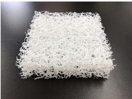
②ブレスエアー® 中空-中実 45kg/m<sup>3</sup> 60 mm
